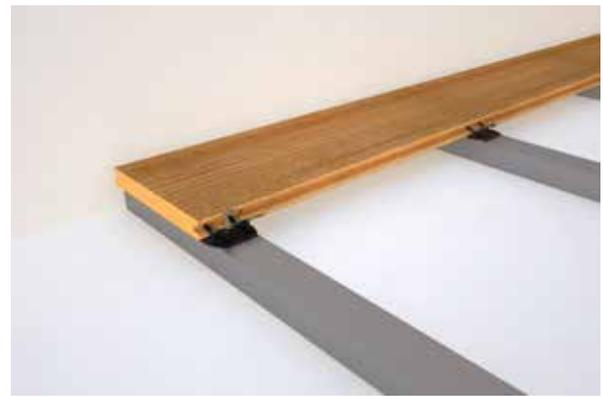
2. Inserire la clip ZCLE-F-IN nell'apposita sede del longherone e fissarla con la vite autoforante 3.5x19 mm.
