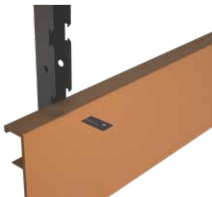
3. Applicare la clip per il PUNTO FISSO sul profilo con viti autopercoranti.
