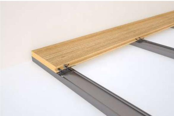
3. Inserire la clip ZCLG-AC017 nell'apposita sede del longherone e fissarla con la vite autoforante 3.5x19 mm.
