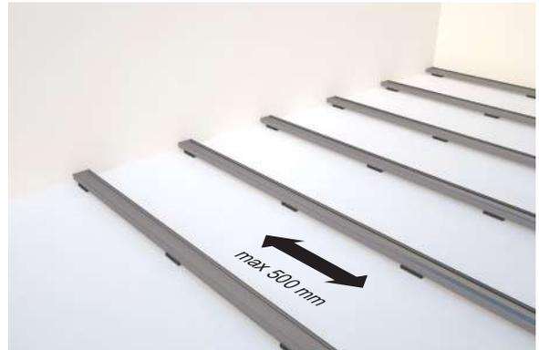
4. Qualora il fondo presenti delle irregolarità e sia pertanto necessario eseguire degli spessoramenti, è necessario garantire un appoggio dei magatelli in alluminio almeno ogni 500 mm.
