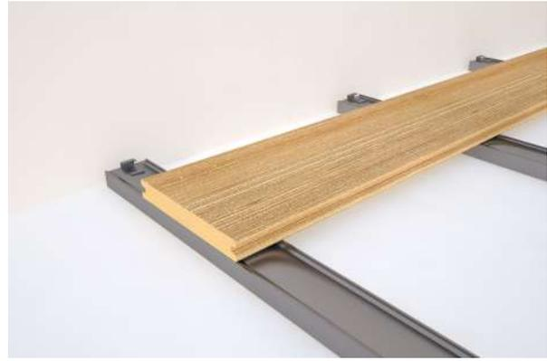
2. Applicare la clip di partenza ZCLG-AC003 avvitandola al magatello assicurandosi che le clip siano tutte allineate. Installare la prima doga inserendone il lembo inferiore nella cavità della clip.
