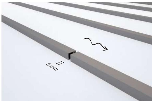
5. La distanza tra le estremità di magatelli contigui deve essere almeno 5 mm nel caso di installazione degli stessi lungo il verso di pendenza del pavimento e 30 mm nel caso di installazione perpendicolare alla pendenza, per consentire il deflusso delle acque meteoriche.
