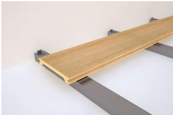
1. Applicare la clip di partenza ZCLG-AC003 avvitandola al magatello assicurandosi che le clip siano tutte allineate. Installare la prima doga inserendone il lembo inferiore nella cavità della clip.
