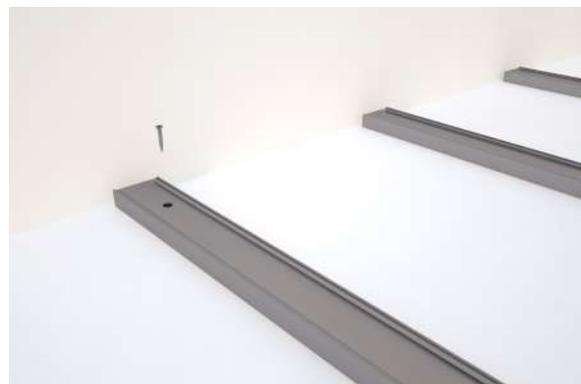
2. Eseguire un preforo passante di diametro 1-2 mm superiore al diametro del gambo della vite e un altro di diametro superiore al diametro della testa della vite in corrispondenza della superficie superiore del magatello.
