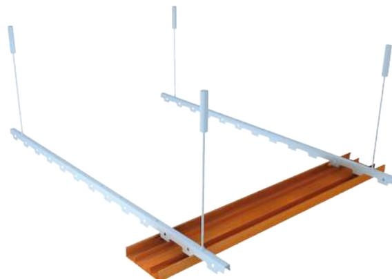
2. Installare il primo profilo TH14830HD-4 incastrando le doghe alla sottostruttura alternandole al profilo THZ5004HD se previsto.
